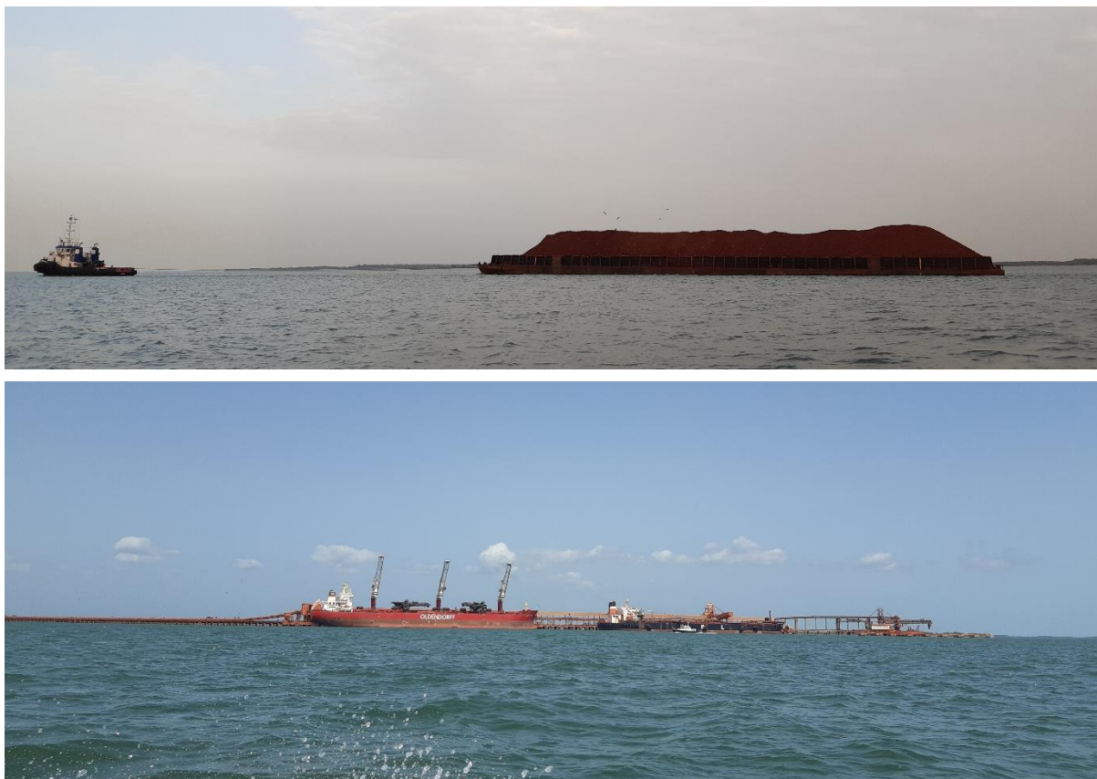
Figure 11. Exemple d'infrastructures liées aux activités minières dans le Rio Nuñez (en haut : barge de bauxite transportée vers les cargos au large ; en bas : quai et convoyeur pour charger la bauxite dans les cargos)
